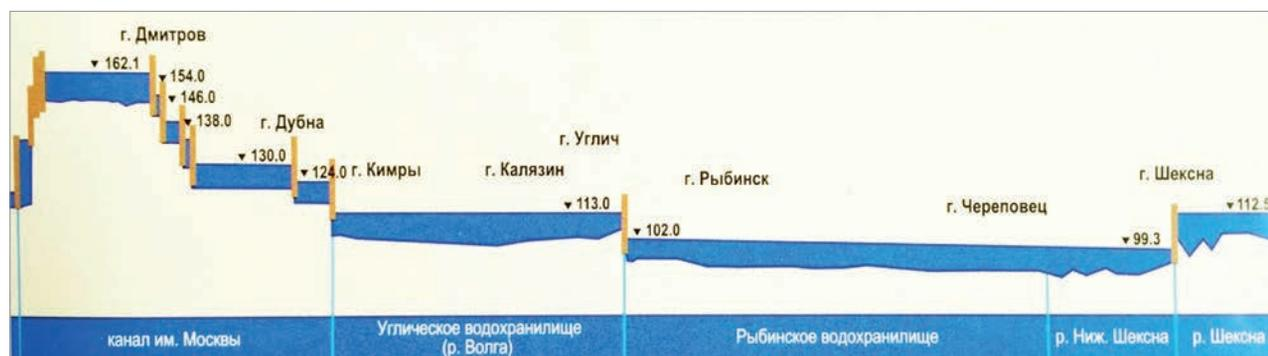
Рис. 1. Продольный разрез водного пути Москва-Белозерск. Источник: [5]
