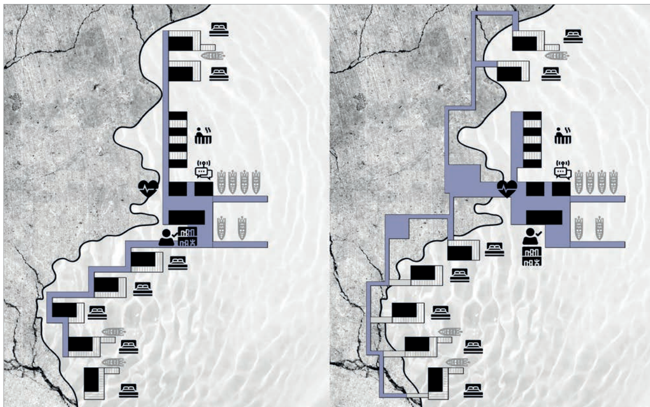
Рис. 3. Варианты организации пешеходных связей: по понтонам (справа), с выходом на берег (слева)
