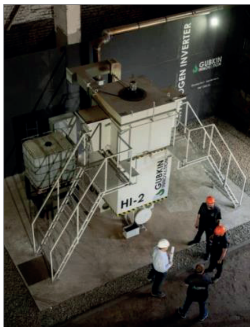
Рис. 3. Экспериментальная установка плазменного сжигания мусора
