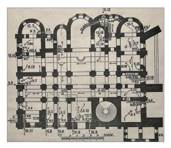
Рис. 2. План Софийского Собора в Новгороде с показанием приборов отопления м вентиляции (К. І., К. ІІ и К. ІІІ – камеры побудительной тяги) (чертеж 2) [2]
